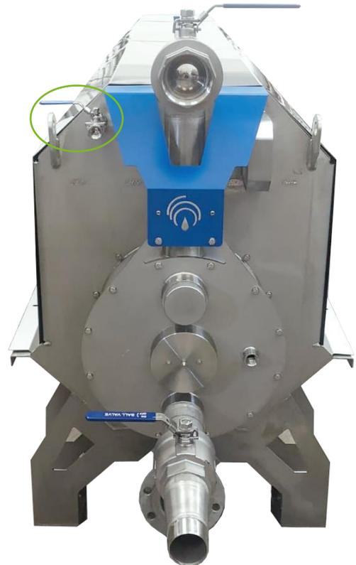
Il lavaggio deve essere alimentato da acqua tecnica con una pressione minima di 5/6Bar.
