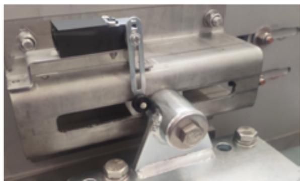
Limitatore di coppia elettronico a finecorsa
