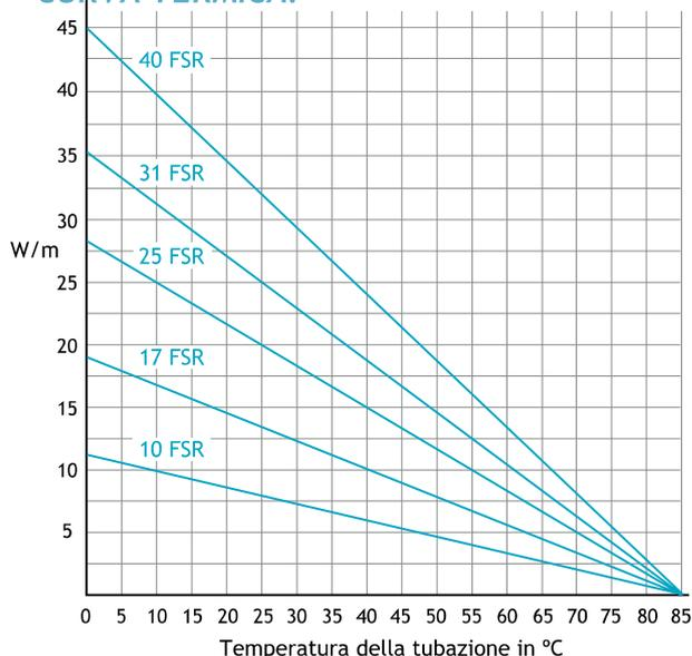
Il grafico mostra la potenza nominale fornita con alimentazione a 230 V c.a. e il cavo installato su una tubazione di metallo opportunamente coibentata e dimensionato secondo le norme IEC 62395 e IEC 60079-30.
